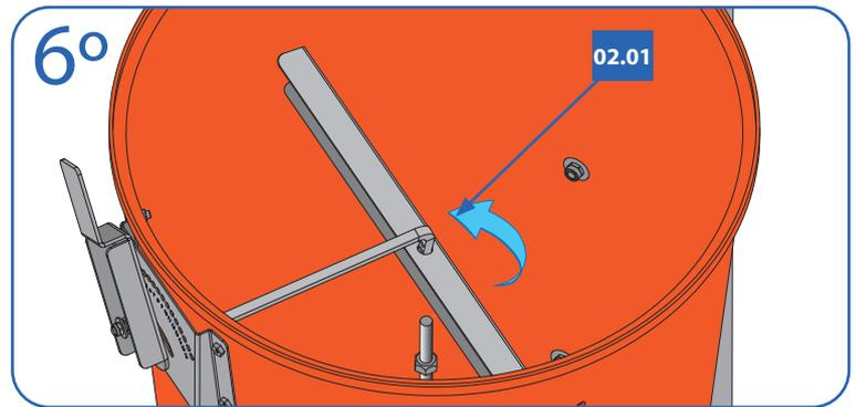
**Paso 7:** Se insertan las arandelas, el acople y la tuerca por la varilla del girador hasta hacer tope con la tuerca.
