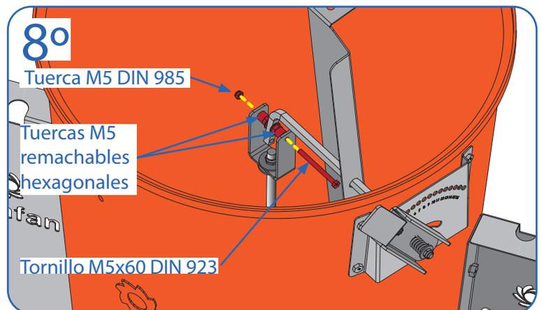
**Paso 9:** Se coloca el travesaño en su posición y se termina de fijar como indica el dibujo.
