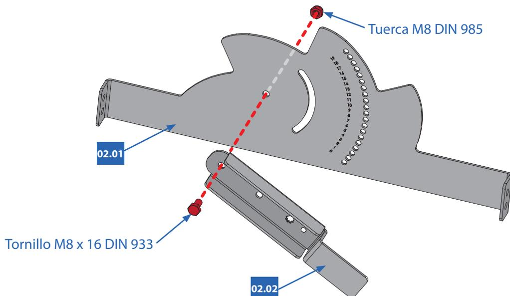
Paso 2: Se une el acople al conjunto de la regulación con la siguiente tornillería.
