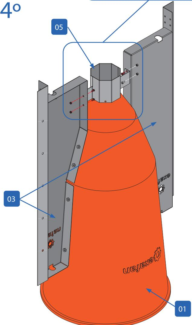
**Paso 5:** Con una broca de Ø 6 mm se perforan los cuatro agujeros que nos marca la pieza hexágono 05 para poder fijar la tolva 01.
