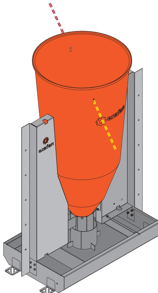
Paso 4: Se introduce todo el conjunto de regulación por la varilla del girador hasta hacer tope con la tuerca inferior.
