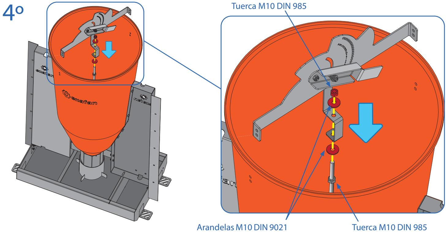
Paso 5: Se fija la regulación por los agujeros perforados previamente.
