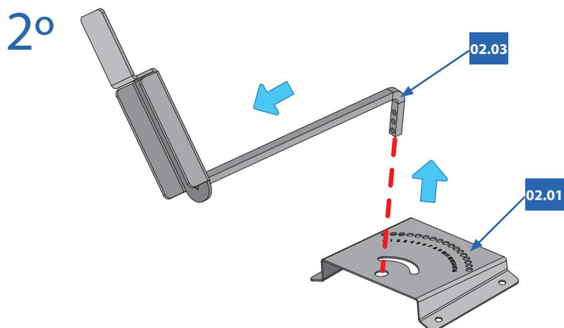
Paso 3: Se une la chapa regulación con la maneta mediante la siguiente tornillería.
