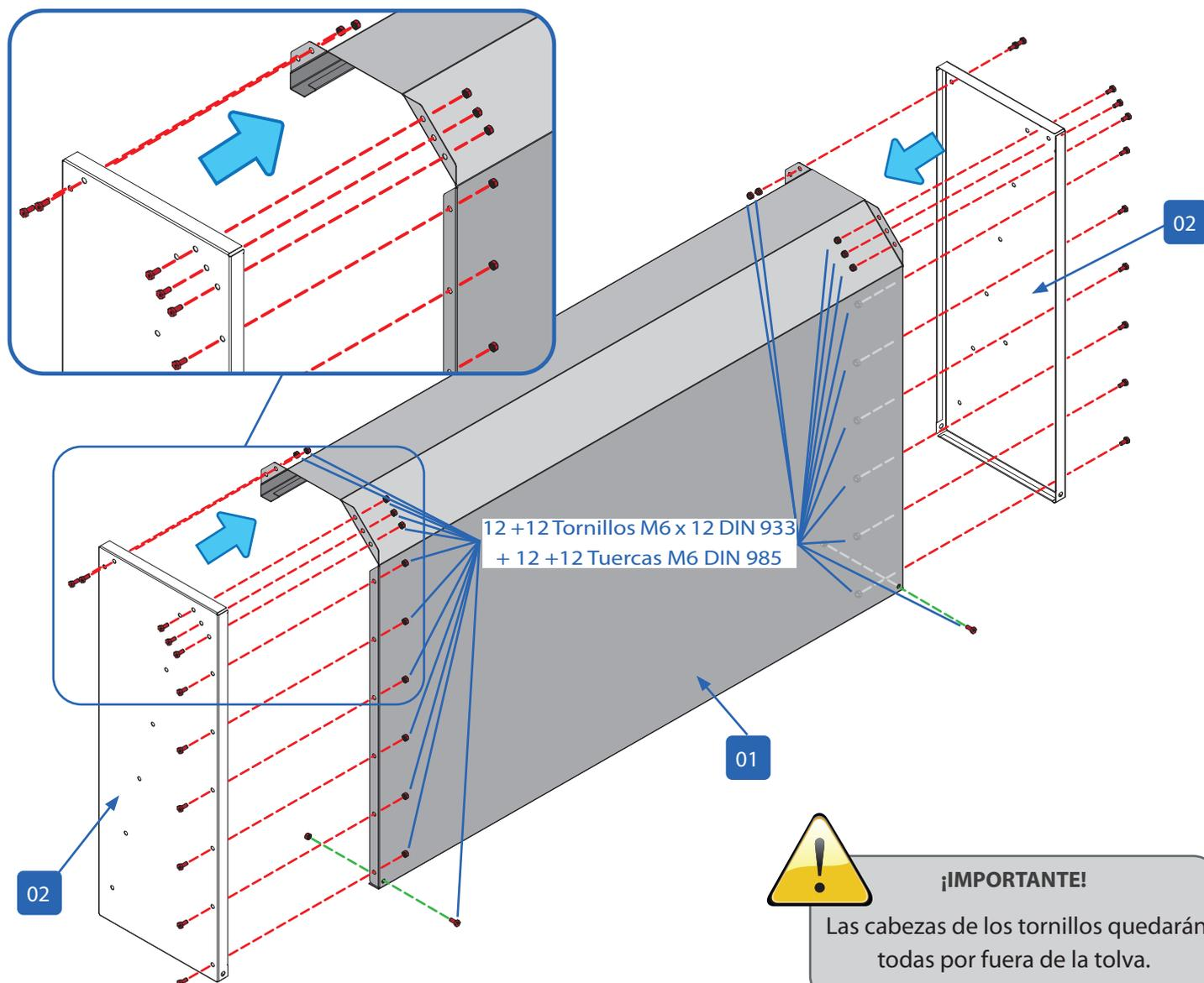
**Paso2:** Para colocar la chapa frontal (03) se gira la tolva 180°. Insertar la tapa frontal dentro de la tolva. Cuando se realice esta operación hay que asegurarse que el panel frontal queda situado detrás de los agujeros para la guía en "U". Los agujeros en las chapas laterales (2) deben coincidir con los agujeros de las solapas de la pieza frontal (03).
