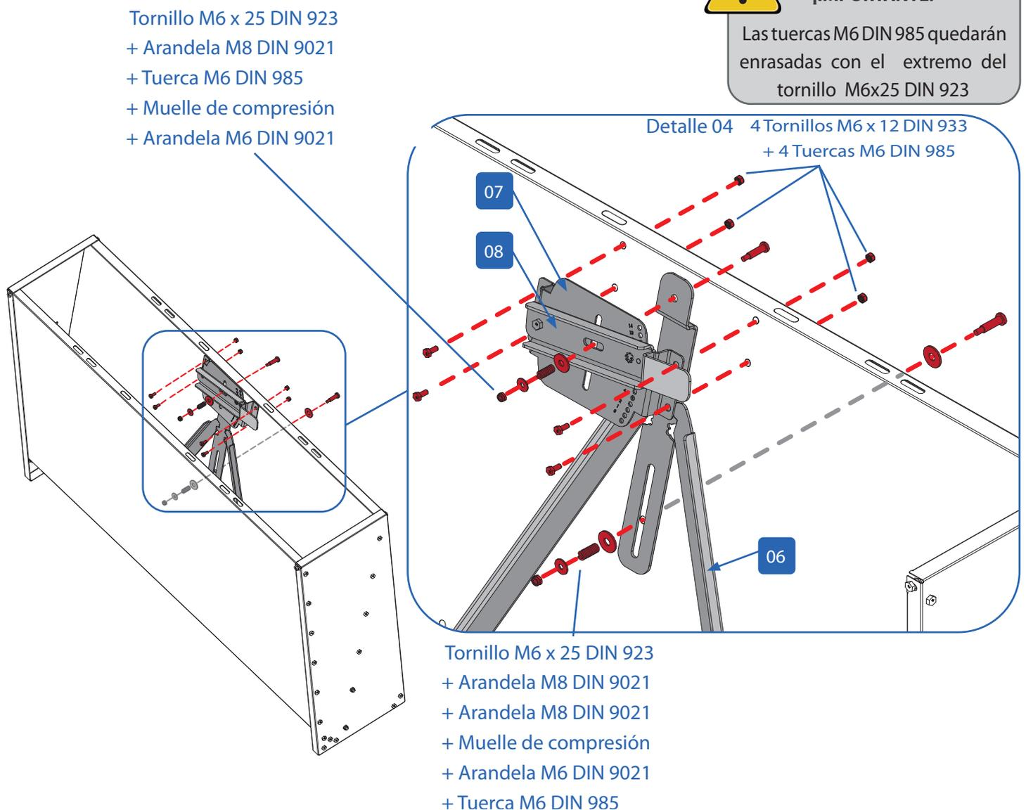
**Paso 8:** Colocar las barras divisoras: cada barra divisora lleva dos tuercas M8 DIN 934 y dos tuercas de freno M8 DIN 985 colocadas de la siguiente manera:
