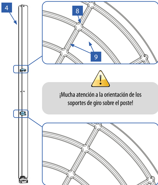
Fig. 10.4. Remachado de los soportes de giro.
